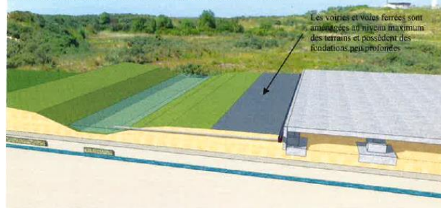
Etape 5 : fonctionnement du site avec évacuation gravitaire des eaux de pluie
