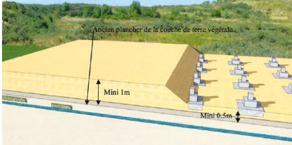
Etape 2 : Remblai sableux du site d'environ 1m d'épaisseur, établissement des fondations type « patte d'éléphant » des entrepôts sur 0.5m de lit sableux.
