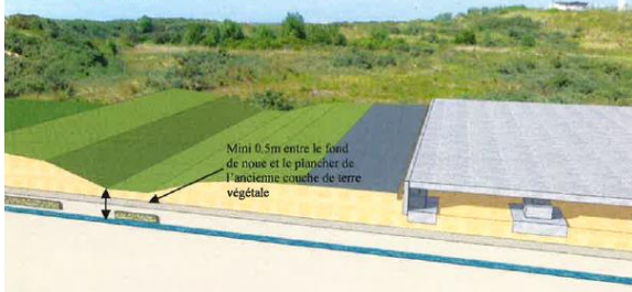
Etape 4 : modelage des noues de gestion des eaux de pluie
